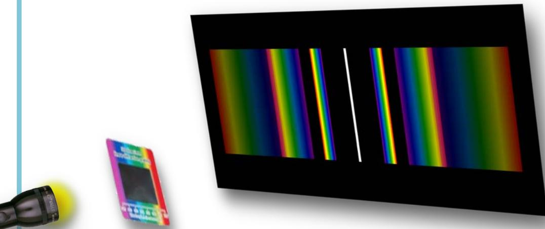
*Spectre de la lumière obtenu à l'aide d'un réseau ...*
