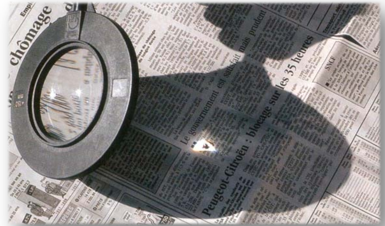
Figure 4 – Une lentille convergente faire converger les rayons du Soleil en un point
