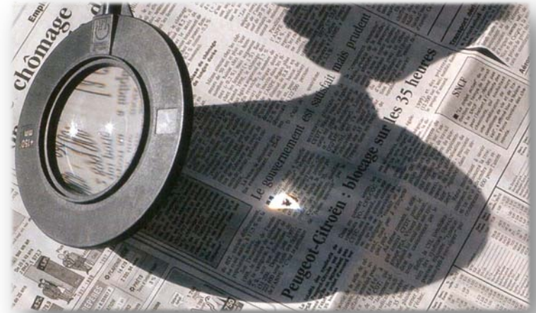
Figure 4 – Une lentille convergente fait converger les rayons du Soleil en un point
